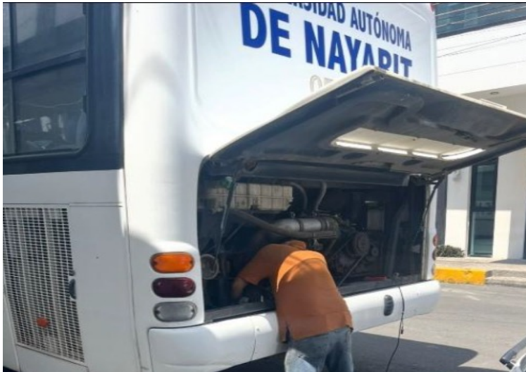
Foto 101. Autobús oficial con servicio de mantenimiento de motor, cambios de filtros de aire primario y secundario, filtro de cartucho para diésel, cartucho para aceite, filtro separador de diésel y aceite de motor 15w-40, enero 2026.
